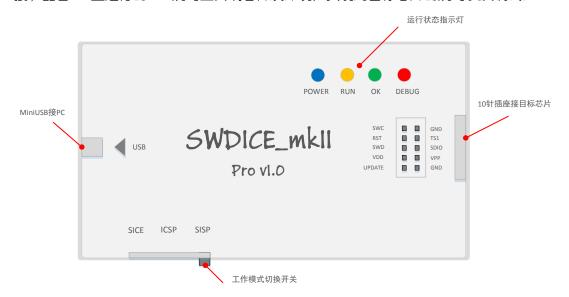
SWDICE\_mkII Pro 可工作于三种模式。三种模式可以通过"工作模式切换开关"进行选择。 改变工作模式后,需要重新上电,才能正确的工作于选择的模式。
